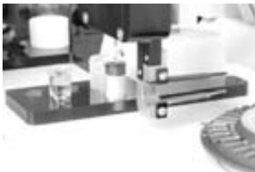
**Fig. 1** Passeur d'échantillons entièrement automatique SSA 600L avec option liquide
